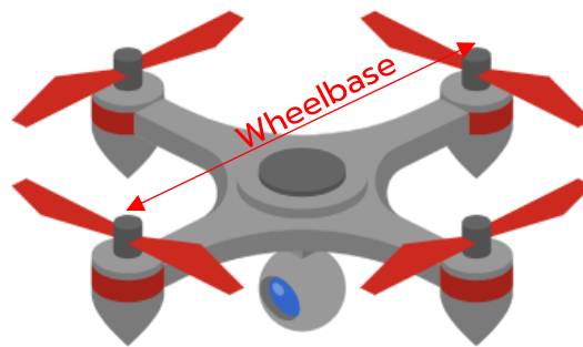
ภาพที่ 8: การวัด Wheelbase
